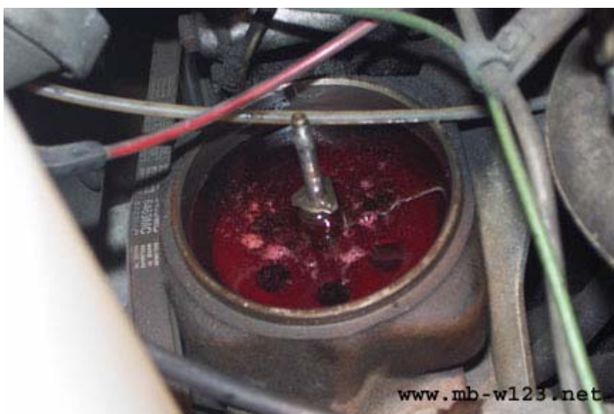
So sollte das Servoöl nach dem Wechseln aussehen.
