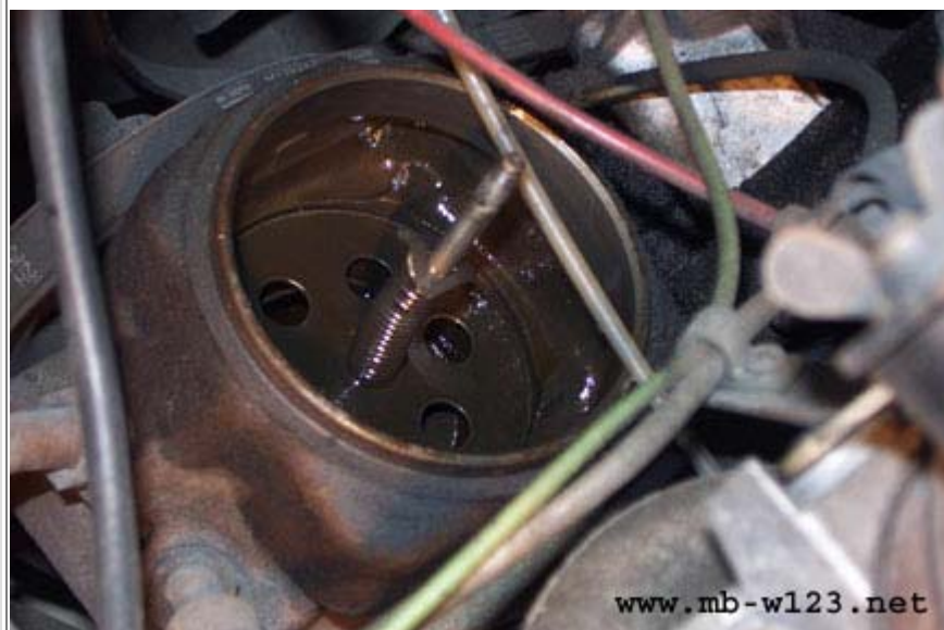
Hier ist die Servopumpe noch im ungereinigtem Zustand.
